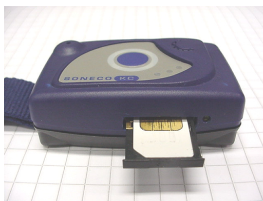
Sätt i SIM-kortet och tryck tillbaka hållaren.
