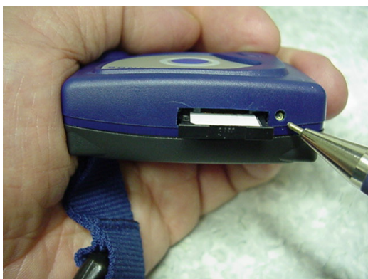
Tryck på den lilla knappen som syns i bilden. SIM-korthållaren öppnas.
